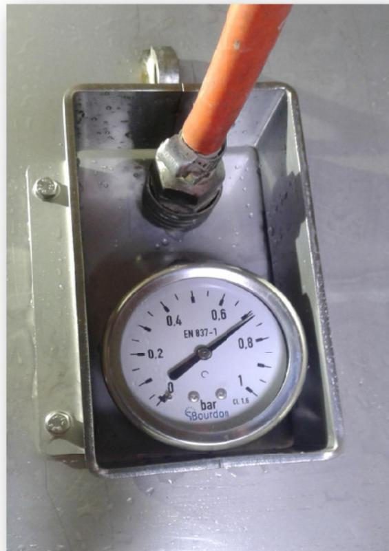
Abbildung 4: Erfolgreiche Druckprüfungen beim Innen-Verschlussdeckel
